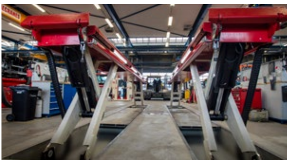
Automatische Abdeckplatten für Aussparungen im Boden
