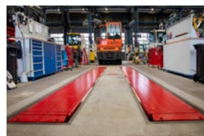
Im Boden versenkt mit Abrollschutz
