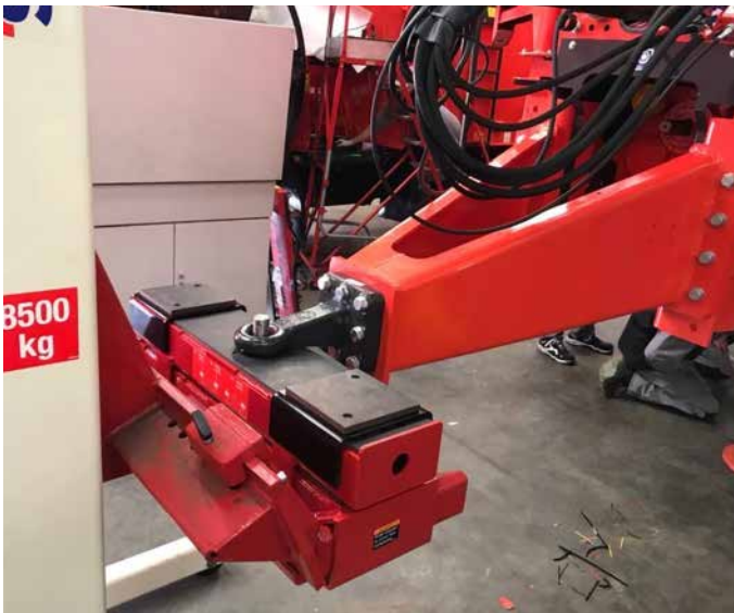
Mehrzweckadapter für das radfreie Anheben von Fahrzeugen vorne oder hinten mit zwei oder drei mobilen Hebesäulen.
