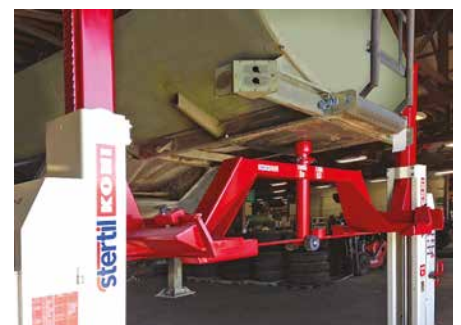
Quertraverse mit Königszapfenaufnahme zum sicheren und unabhängigen Anheben eines Aufliegers ohne Zugmaschine.
