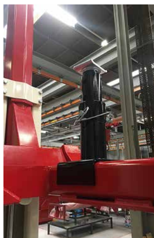
Quertraverse mit Königszapfenaufnahme zum sicheren und unabhängigen Anheben eines Aufliegers ohne Zugmaschine.
