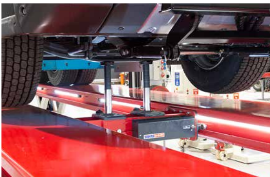
Die einstellbaren Achsfreiheber mit zwei Hubzylinder passen auf alle Fahrflächen.
