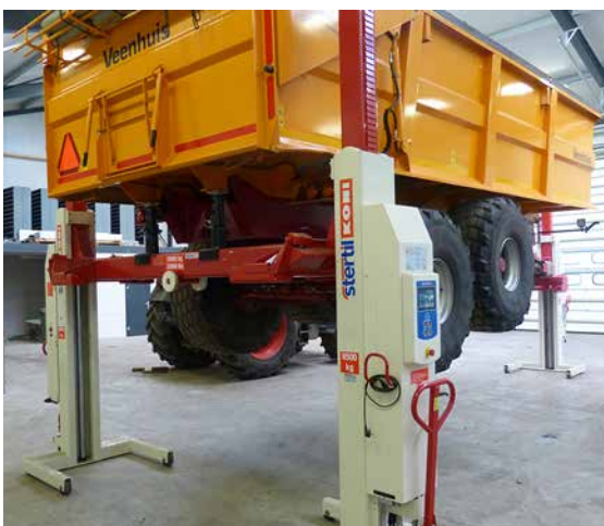
Extra flache Quertraversen für besseren und radfreien Zugang.
