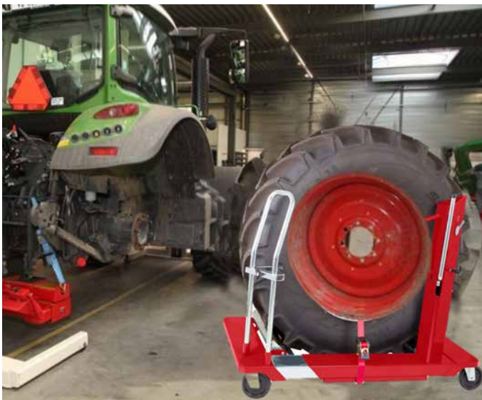
Radmontagewagen für den bequemen und ergonomischen Ausbau von großen Rädern.
