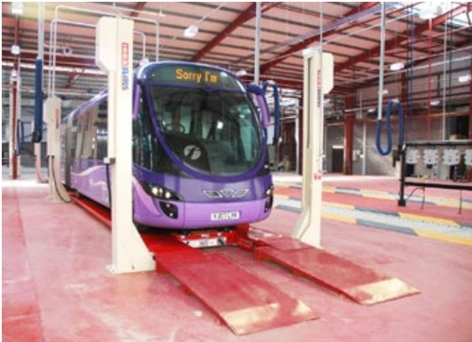
Die breiten Fahrflächen haben eine extrem niedrige Auffahrhöhe und eignen sich daher ideal für Fahrzeuge mit geringer Bodenfreiheit wie zum Beispiel Nahverkehrsbusse. Die standardmäßigen Auffahrrampen haben ein optimiertes und effizientes Design.
